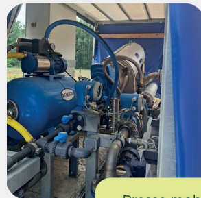
Presse mobile de déshydratation des boues
