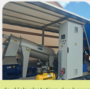
Presse mobile de déshydratation des boues
